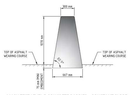
MASH TEST LEVEL 5 CONCRETE BARRIER - CONSTANT SLOPE
