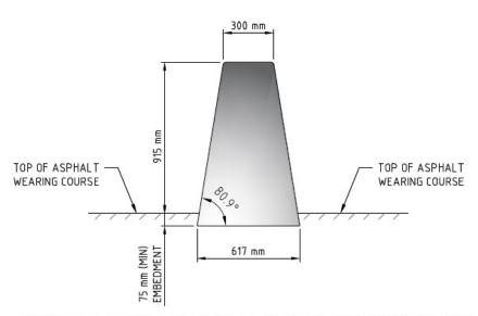
MASH TEST LEVEL 4 CONCRETE BARRIER - CONSTANT SLOPE
