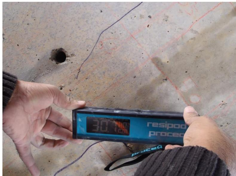
**Figure 14 - TYPICAL CONCRETE RESISTIVITY TEST**
