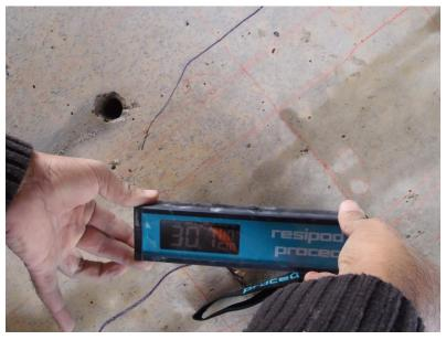
Figure 14 - TYPICAL CONCRETE RESISTIVITY TEST
