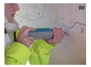
Figure 10 – REBOUND HAMMER TEST TAKING 25 TEST POINTS BEFORE COMPRESSION (a) AND AT FULL COMPRESSION (b)
